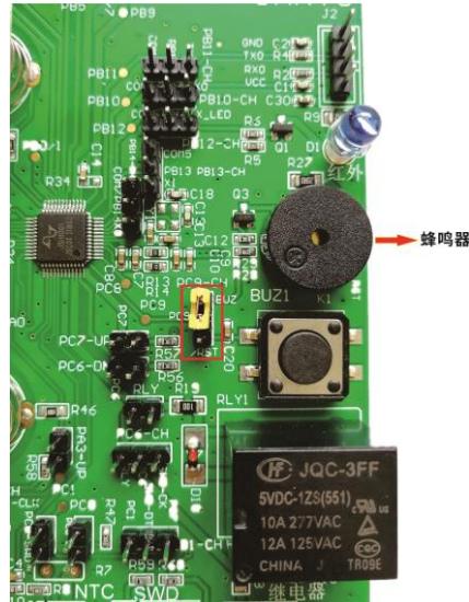
图 7 蜂鸣器短接帽接法
