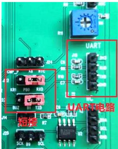
图 10 UART 模拟电路
