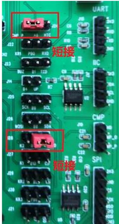
图 13 CMP 模块电路
